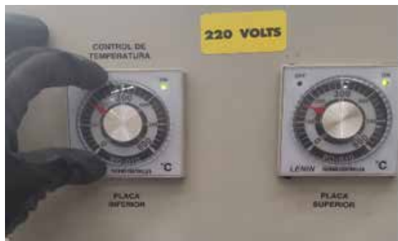
15 Girar pirómetro superior en la posición de 140°C e inferior a 160°C
