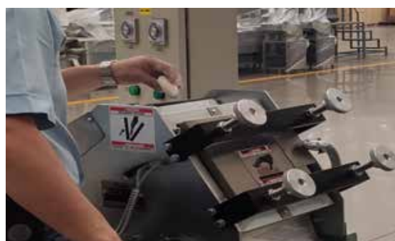
18 Colocar masa en testal de prensa de leva
