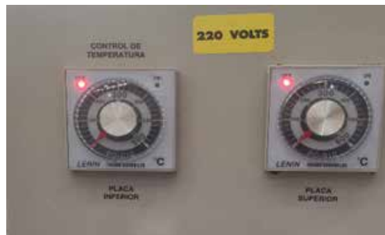
14 Verificar que los pirómetros se encuentren en posición de 0°C
