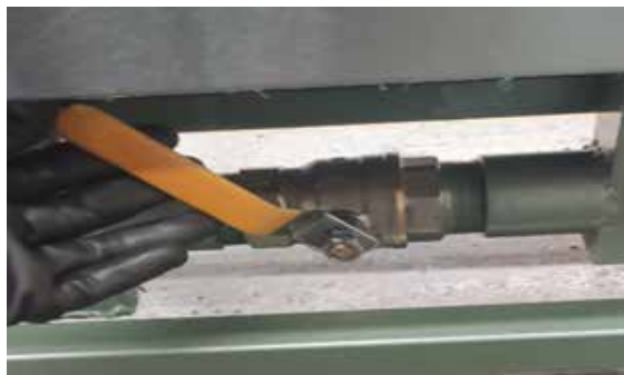
23 Abrir conducto de gas del tercer nivel del chasis
