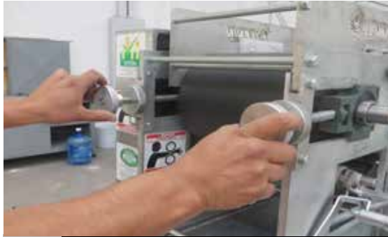
29 Regular grosor de tortilla girando las perillas de ajuste (sentido horario adelgaza la tortilla) bajar la palanca de clutch al obtener el grosor deseado
