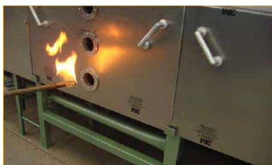
11 Encender las boquillas y comenzar carburación
