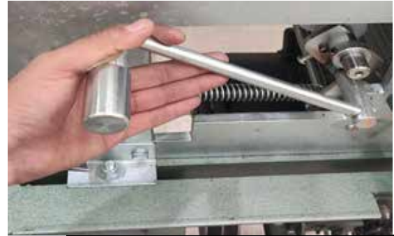
30 Levantar palanca del cortador
