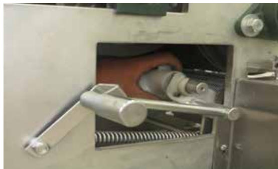
24 Verificar que el cortador esté correctamente ensamblado.
