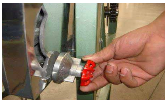
9 Verificar que la llave del carburador este en la posición 0
