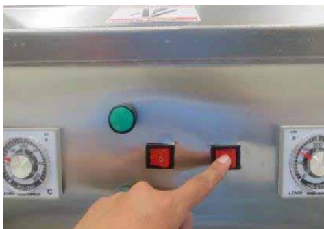
3 Encender switch de control de temperatura
